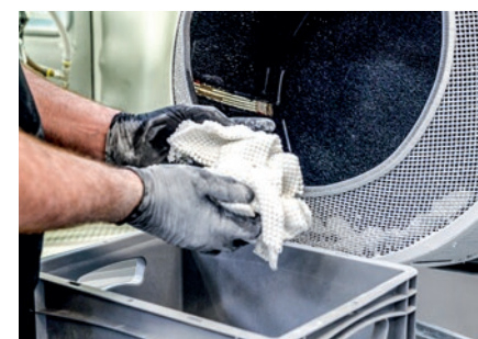
Foto oben: Die Bauteile beim Entladen aus der Powershot C (Cleaning)
